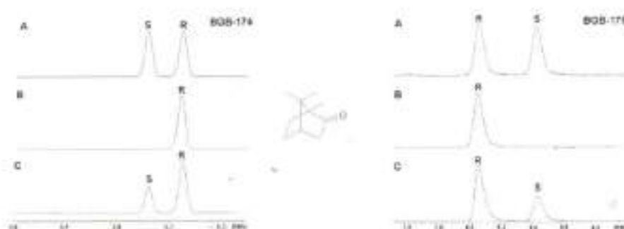
Figura 5. Cromatogramas representativos da inversão da ordem de eluição dos enantiômeros da cânfora em função da cavidade da ciclodextrina. BGB-174, 50% de 2,3-di-O-acetil-6-O-t-butildimetilsilil- \beta -ciclodextrina; BGB175, 50% de 2,3-di-O-acetil-6-O-t-butildimetilsilil- \gamma -ciclodextrina. A, (R,S)-(+)-cânfora; B, (R)-(+)-cânfora; C, co-injeção de (R,S)-(+)-cânfora e (R)-(+)-cânfora). A facilidade de obtenção e baixo custo da \beta -ciclodextrina popularizou essa fase, empregada em 98% das aplicações da literatura. O uso da \gamma -ciclodextrina começa a ficar mais popular e seletividades inesperadas têm ocorrido. Um complicador a mais na difícil tarefa de racionalizar os mecanismos de seleção quiral de ciclodextrinas substituídas. A modelagem da docagem nesses sistemas multipolintômicos, parece ser uma abordagem promissora 147 .
